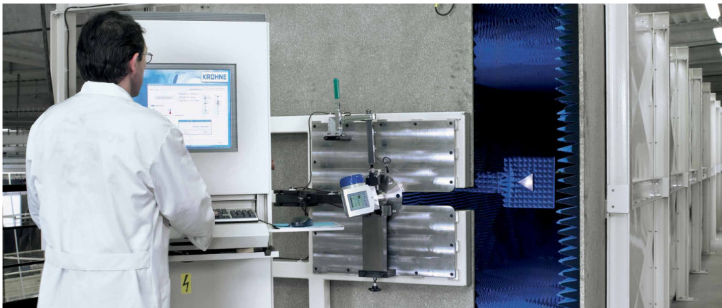
Участок калибровки радарных FMCW преобразователей уровня
